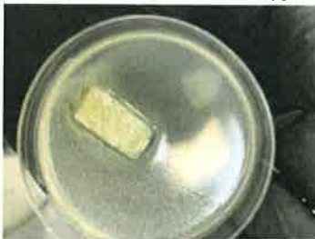
Rys. 2 Filtr z naniesioną potencjalną warstwą bakteriostatyczną z widocznym efektem „halo” (obszar dookoła filtru nieporośnięty koloniami bakterii)
